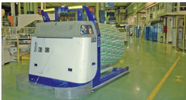
Figura 7. Las bobinas de papel son transportadas por vehículos autónomos que las depositan y recogen en los puntos habilitados en distintas secciones.
